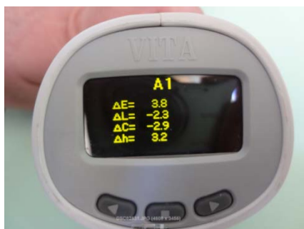
الشكل رقم (12): يبين قراءة أبعاد اللون والتغير اللوني \Delta E كما يعطيها جهاز EasyShade
