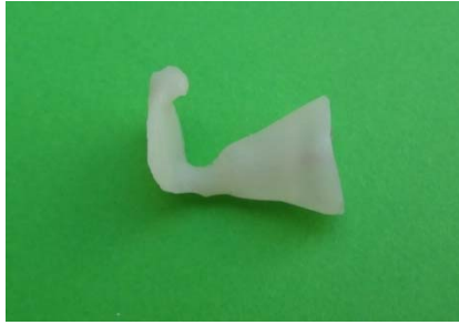
الشكل رقم (3): يبين القالب الخزفي المستخدم في تصنيع الدعامات
