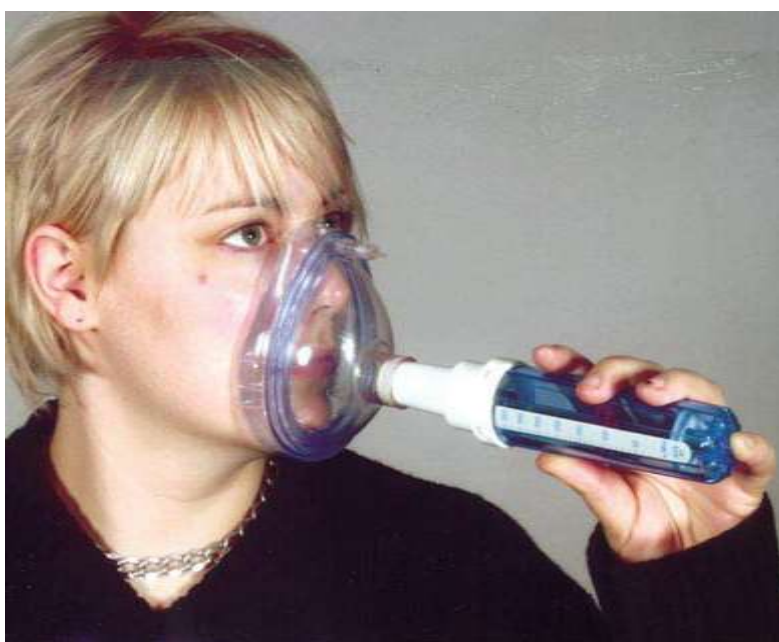
الشكل رقم ( 5 ) : طريقة إجراء قياس حجم الهواء المستنشق
