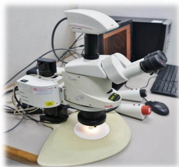
الشكل (5): المكبرة الضوئية المستخدمة في فحص العينة
