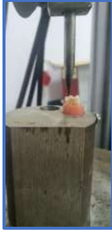
الشكل (4) استخدام جهاز الاختبارات الميكانيكية لتطبيق القوة على عينة البحث باستخدام رأس خاص على شكل حد السكين عند السطح البيني (قرص-سن).
