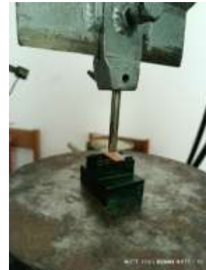
الشكل (12) اختبار قوة القص باستخدام آلة الاختبارات العامة
