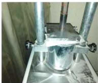
الشكل (3) نضع قالب العينات تحت المكبس
