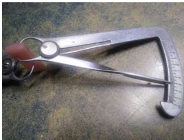
الشكل (6) التأكد من قياسات العينات الإكريلية باستخدام مقياس السماكة
