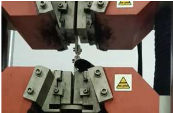
الشكل (13) اختبار قوة الشد باستخدام آلة الاختبارات العامة
