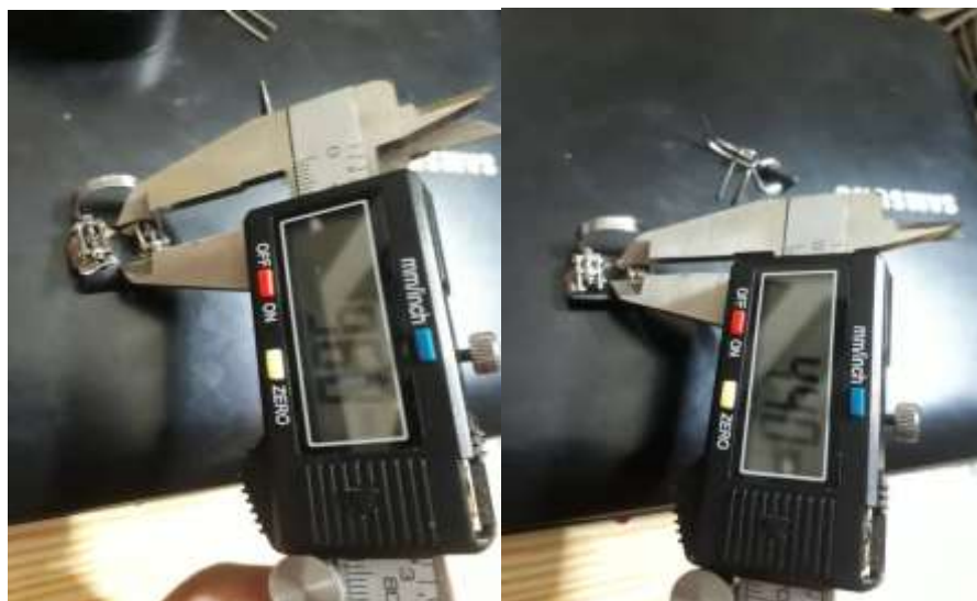
الشكل(3): قياس متوسط المسافة التي يمكن أن يتحرك ضمنها المشبك
