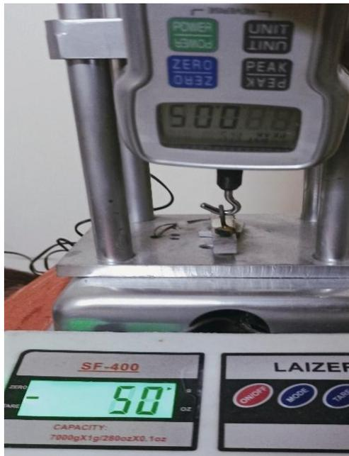
الشكل رقم (4): قراءة لمعايرة جهاز التجربة مع جهاز له موثوقية جيدة حيث نلاحظ تطابق النتيجة
