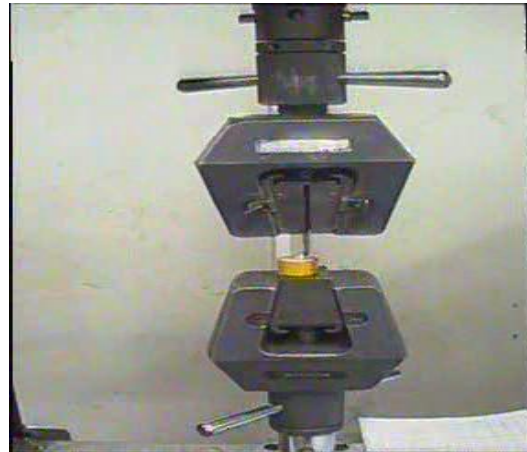
شكل رقم (7) صورة توضح جهاز قياس متانة الارتباط و العينة موجودة ضمنه
