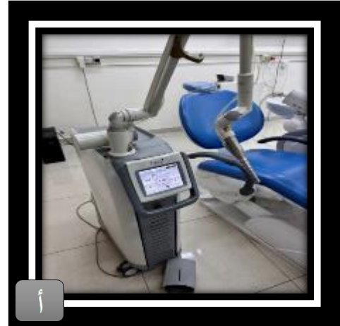
الشكل (4) أ. جهاز ليزر Er:YAG المستخدم في الدراسة (Lightwalker system ST-E; Fotona, Slovenia)
