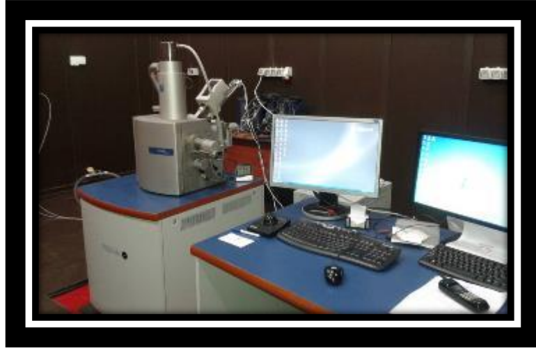
الشكل (7) المجهر الالكتروني الماسح المستخدم بالبحث (Tescan, VEGA II Xmu, Czech Republic)
