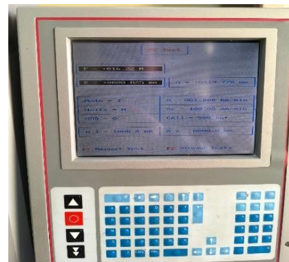
الشكل رقم (10): يوضح وحدة التحكم الخاصة بجهاز الشد حيث ضبطت السرعة 1 ملم/د.
