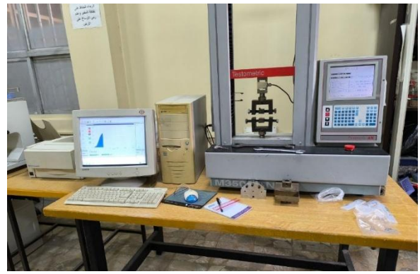
الشكل رقم (8): يوضح جهاز الشد مع مقبضي الجهاز.
