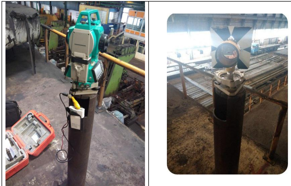
الشكل (6) تقنية التثبيت القسري فوق النقاط الجيوديزية.
