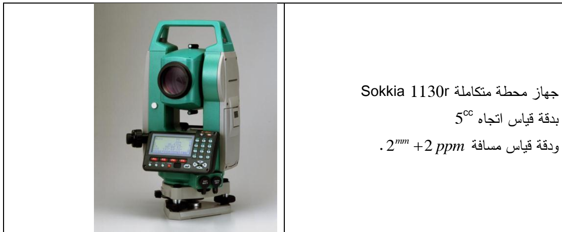
الشكل (5) مواصفات الجهاز المساحي المستخدم.
