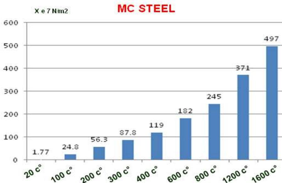
الشكل 9: قيم الإجهادات الناشئة في الوصلة عند درجات حرارة متزايدة للمادة MC Steel
