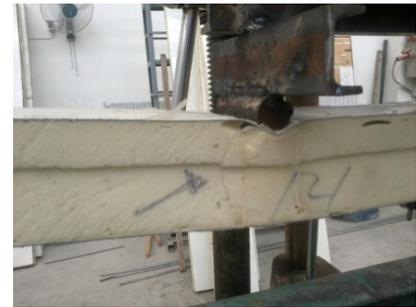
a: صورة للعيينة رقم (2) تظهر التشوه الموضعي الحاصل عند حدوث الانهيار مع انفصال مادة النواة عن بعضها
