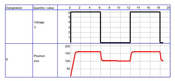
$K_P = 8$  الشكل (8): حركة المكبس من أجل دارة تحكم مغلقة بدون وجود تسريب
