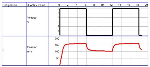
$K_P=2$  الشكل (7): حركة المكبس من أجل دارة تحكم مغلقة بدون وجود تسريب
