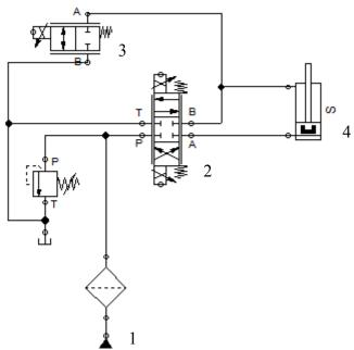
1- مضخة هيدروليكية، 2- صمام تحكم اتجاهي تناسبي، 3- صمام لمحاكاة التسرب، 4- مكبس هيدروليكي 1- مضخة الشكل(2): الدارة الهيدروليكية المدروسة
