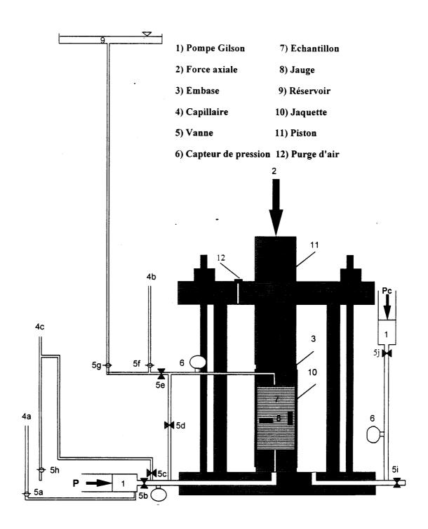
شكل رقم 8 أقسام جهاز الضغط ثلاثى المحاور
