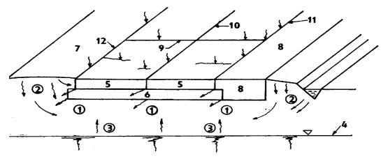
شكل 3 يوضح مقطع الطريق ومناطق تسرب المياه
