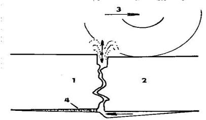
الشكل رقم 2 يوضح تجمع المياه المضغوطة تحت البلاطة البيتونية عند إنتقال العربة إلى البلاطة المجاورة حيث أن: 1 - البلاطة التي إنتقلت منها الحمولة إلى البلاطة المجاورة
