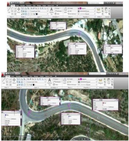
الشكل (2) معالجة الصور الجوية ببرنامج (AutoCAD2010) لاستنتاج العناصر الهندسية على طريق الساحل الغاب
