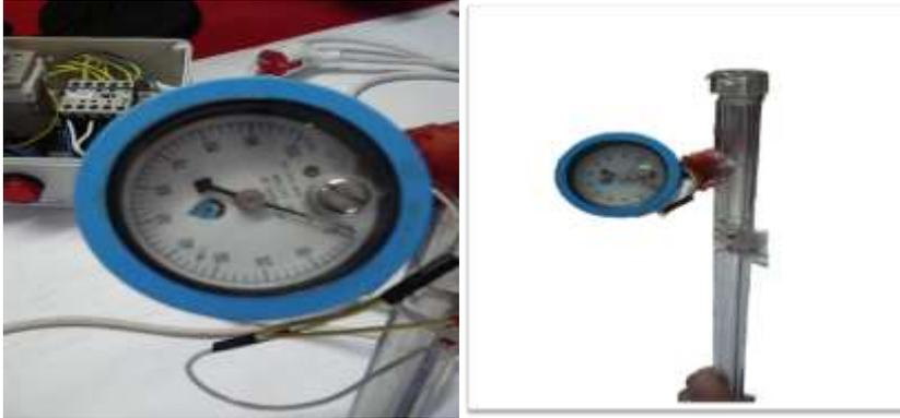
الشكل (1) التثبيومتر المعدل للشكل (2) ساعة مقياس الضغط
