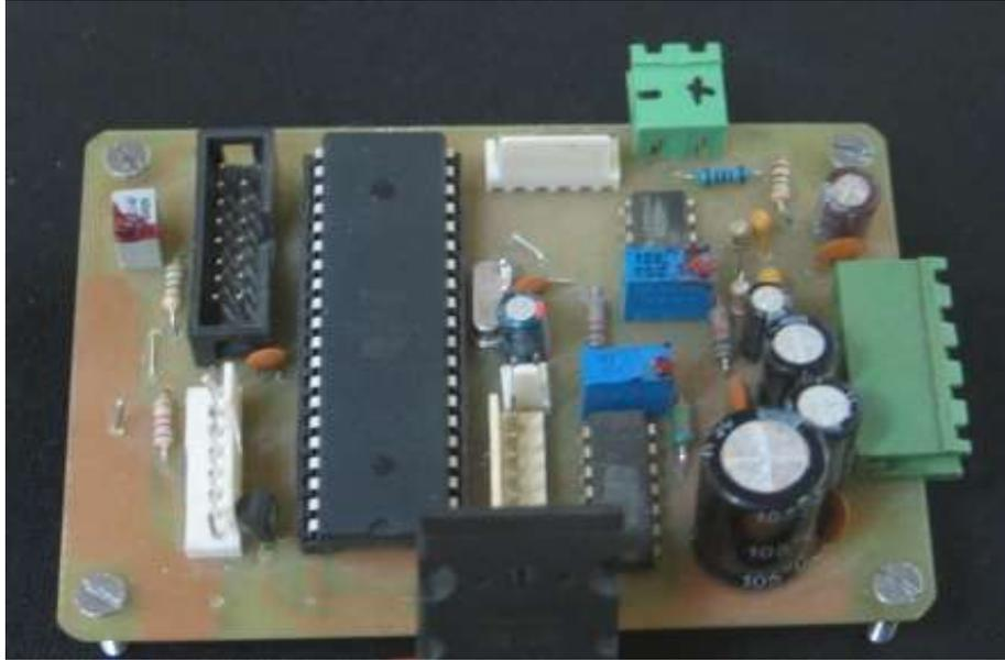
الشكل (14) - لوحة التحكم بالمبدل التي تحوي المعالج التحكمي ATMEGA32
