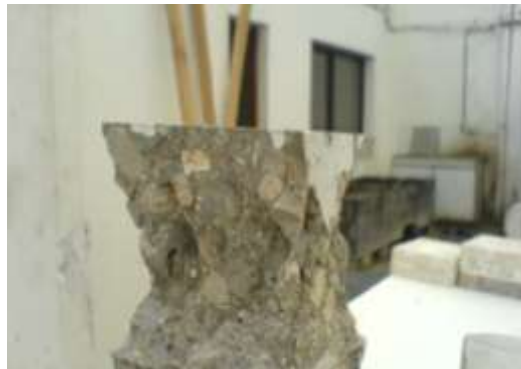
الشكل (14) يبين العينة البيتونية المنهارة وشكل الانهييار كان موحداً في جميع الخلطات أي أن نوع الملدن لا يؤثر في سلوك الانهييار وشكل الانهييار يؤكد تعرض العينة لحمولة ضغط محوري
