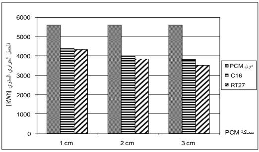
الشكل (3) تأثير سماكة ونوع المادة متغيرة الطور على الحمل الحراري السنوي
