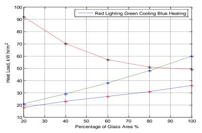
الشكل (2) علاقة استهلاك الطاقة على التدفئة والتبريد والإضاءة مع مساحة الزجاج الحراري المستخدم في واجهات البناء.
