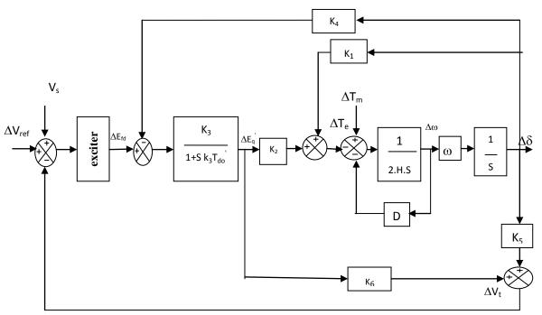
الشكل(2) المخطط الصندوقي لنظام طاقة كهربائية مؤلف من آلة متواقتة موصولة إلى قضيب تجميع لانهائي
