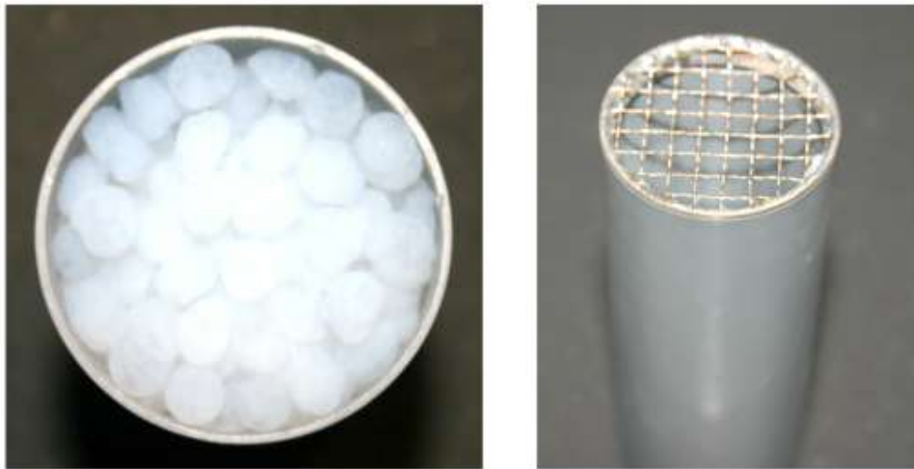
الشكل (6) المجداد المصنَّع من (PVC) مع المبادلات الحرارية (على اليمين)، و حبيبات رمل الصوان (سيليس) (على اليسار).
