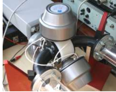
الشكل (7) المصدر الصوتي، مكوّن من ثلاث حجرات للضغط موصولة على التوازي
