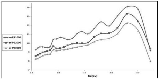
الشكل (8) تغيرات معامل العزل الكهربائي الحقيقي Er بدلالة hv للأفلام الثلاثة.
