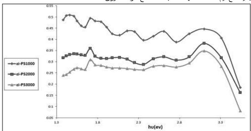
الشكل (9) تغيرات معامل العزل الكهربائي التخيلي ii بدلالة hv للأفلام الثلاثة.
