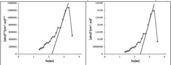
الشكل (11) قيم فجوة الطاقة في الانتقالات المباشرة المسموحة و الممنوعة للفيلم الثاني (2000 RPM) على الترتيب.
