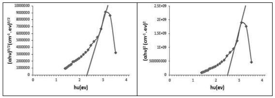
الشكل (10) قيم فجوة الطاقة في الانتقالات المباشرة المسموحة و الممنوعة للفيلم الأول (1000 RPM) على الترتيب.
