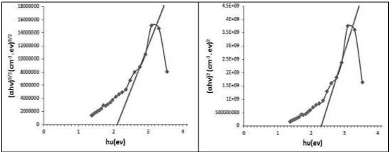
الشكل (12) قيم فجوة الطاقة في الانتقالات المباشرة المسموحة و الممنوعة للفيلم الثالث (3000 RPM) على الترتيب.
