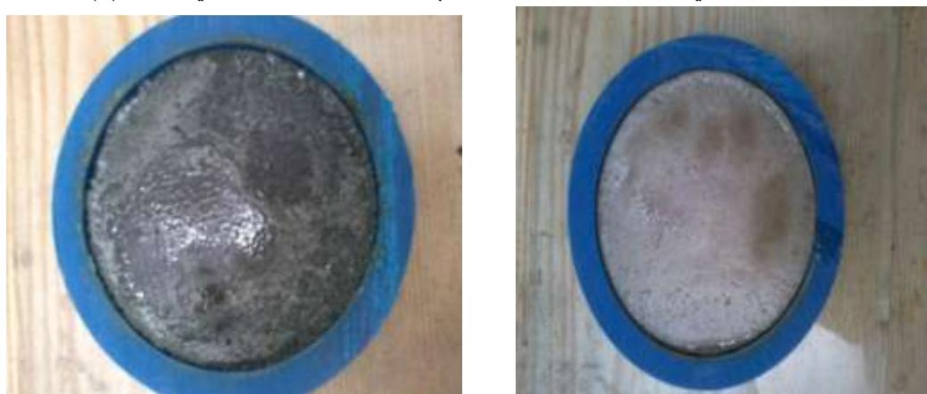
الشكل (4) - عينات الاختبار في القالب
