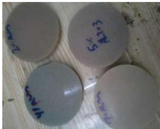
الشكل (5)- عينات الاختبار بعد تمام التصلب.
