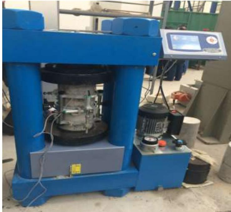
الشكل (4) يوضح جهاز اختبار العينات المحوسب لرسم مخطط إجهاد - تشوه
