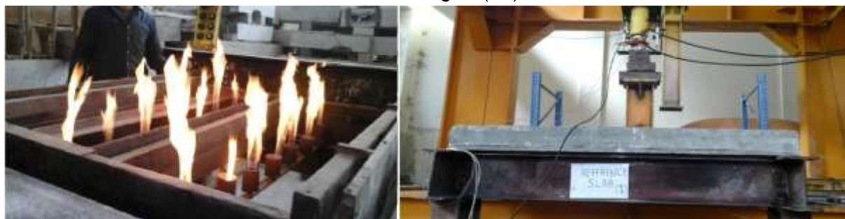
الشكل (2-3) نموذج تحميل البلاطات وطريقة إجراء التجربة والفرن المستخدم لحرق العينات
