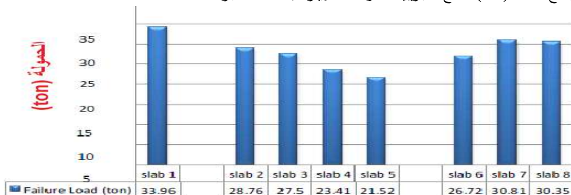
الشكل (3-3) النتائج التجريبية لحمولات الانهيار للبلاطات المجربة
