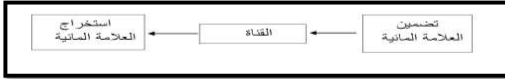
الشكل (1) يوضح بنية نظام العلامة المائية
