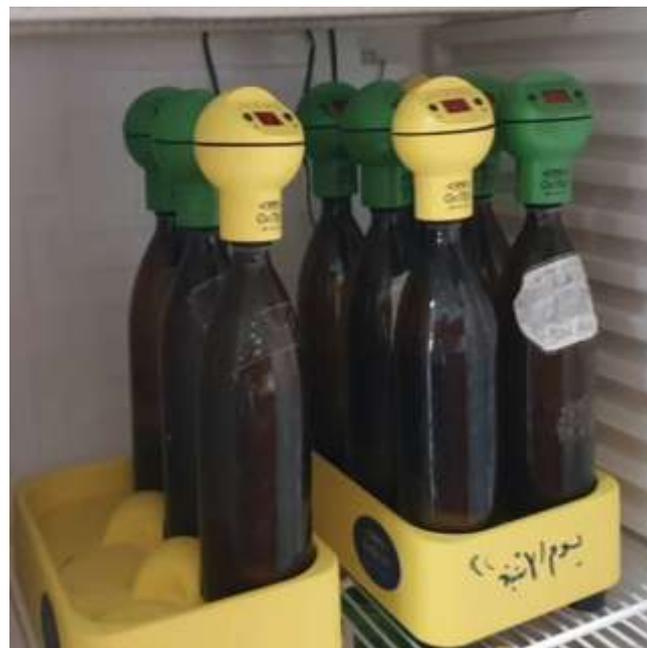
الشكل رقم (12) جهاز قياس BOD5
