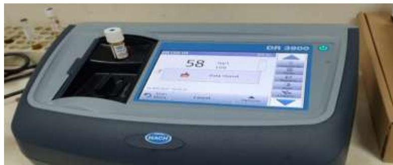
الشكل رقم (11) جهاز قياس COD
