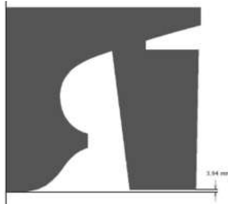
الشكل 2: توضع الدفة خلف نموذج السفينة الناقلة KVLCC2 [29].
