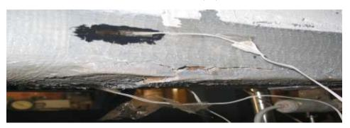
الشكل (11) يبين تمزق صفائح CFRPR
