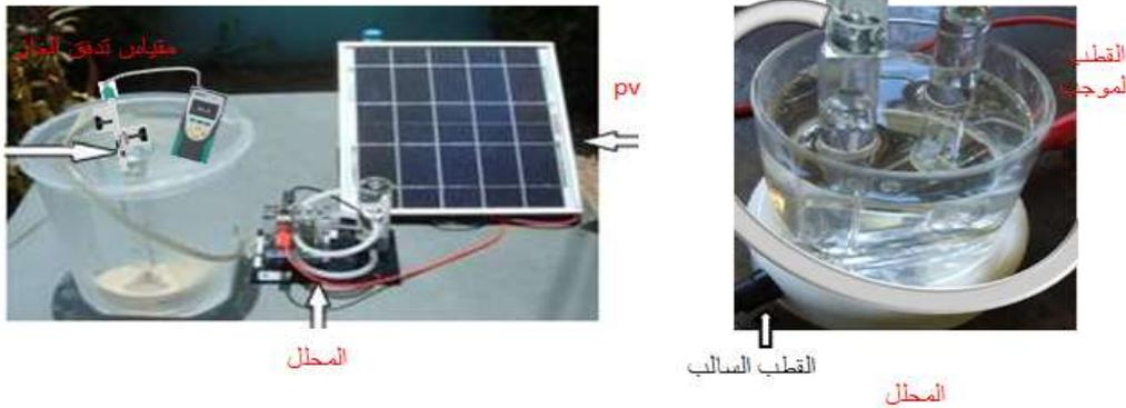
شكل (4) يظهر ربط الخلية الفوتوفولتية مع جهاز التحليل لإنتاج الهيدروجين
