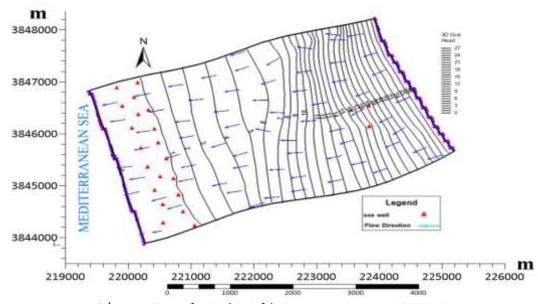
الشكل (15). خطوط تساوي مناسيب المياه الجوفية (m) في الطبقة الحرة للسيناريو الأمثل.
