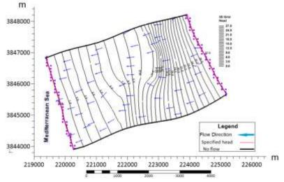
الشكل (12). خطوط تساوي مناسيب المياه الجوفية (m) في الطبقة الحرة- قبل المعايرة
