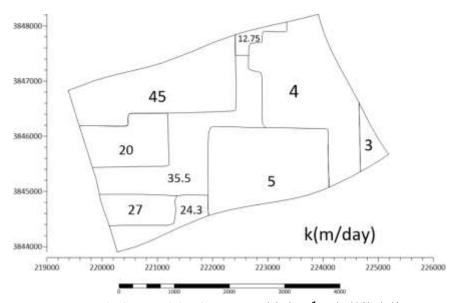
الشكل (10). شريحة عامل الرشح Hydraulic Conductivity Coverage
