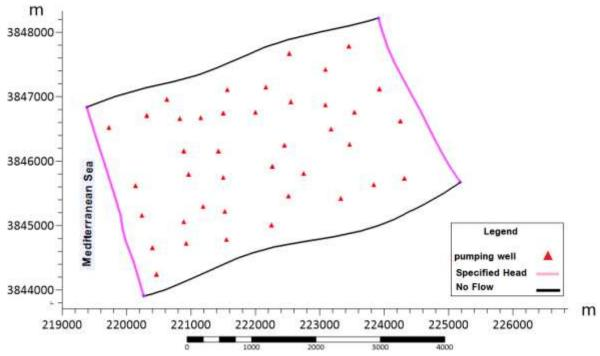
الشكل (8). طبقة التغذية- الصرف Sources/ Sinks Coverage
