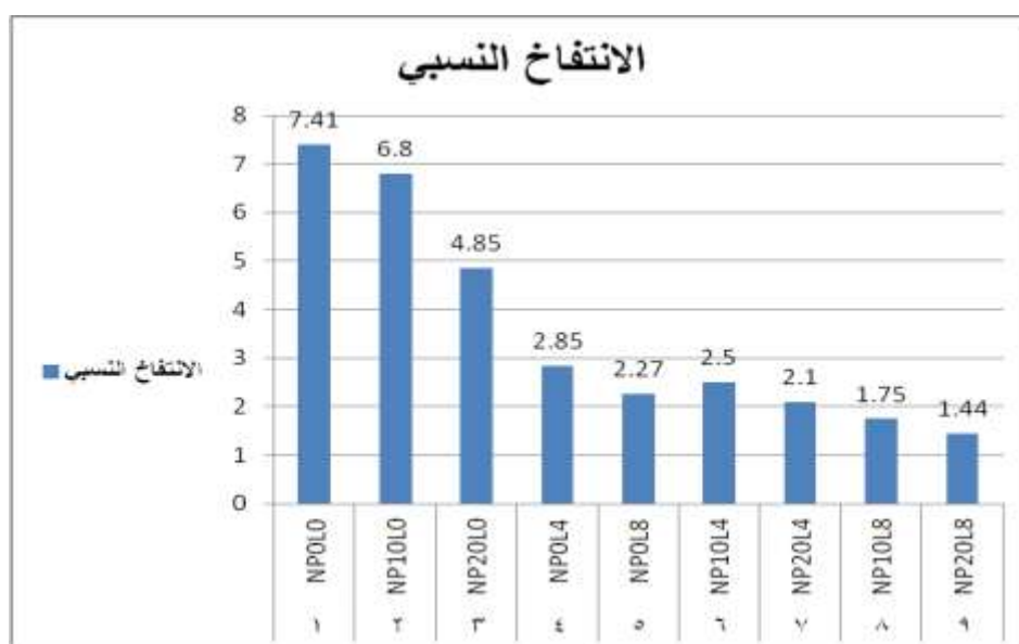
الشكل (3-5) الانتفاخ النسبي مقابل نسب المعالجة المختلفة من الكلس والبوزولانا الطبيعية
