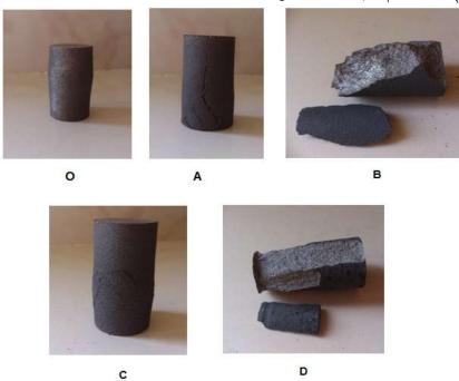
الشكل (5) شكل تحطم العينات بعد اختبار الضغط
