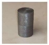
الشكل (2) عينة اختبار الضغط
