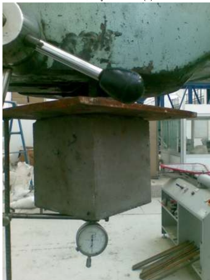
الشكل (6) يبين مقياس التشوه الموضوع على عينة التماسك
