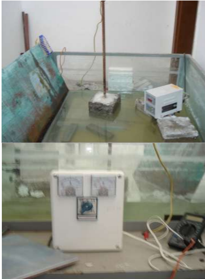
الشكل (3) الخلية الغلفانية وجهاز التآكل المسرع
