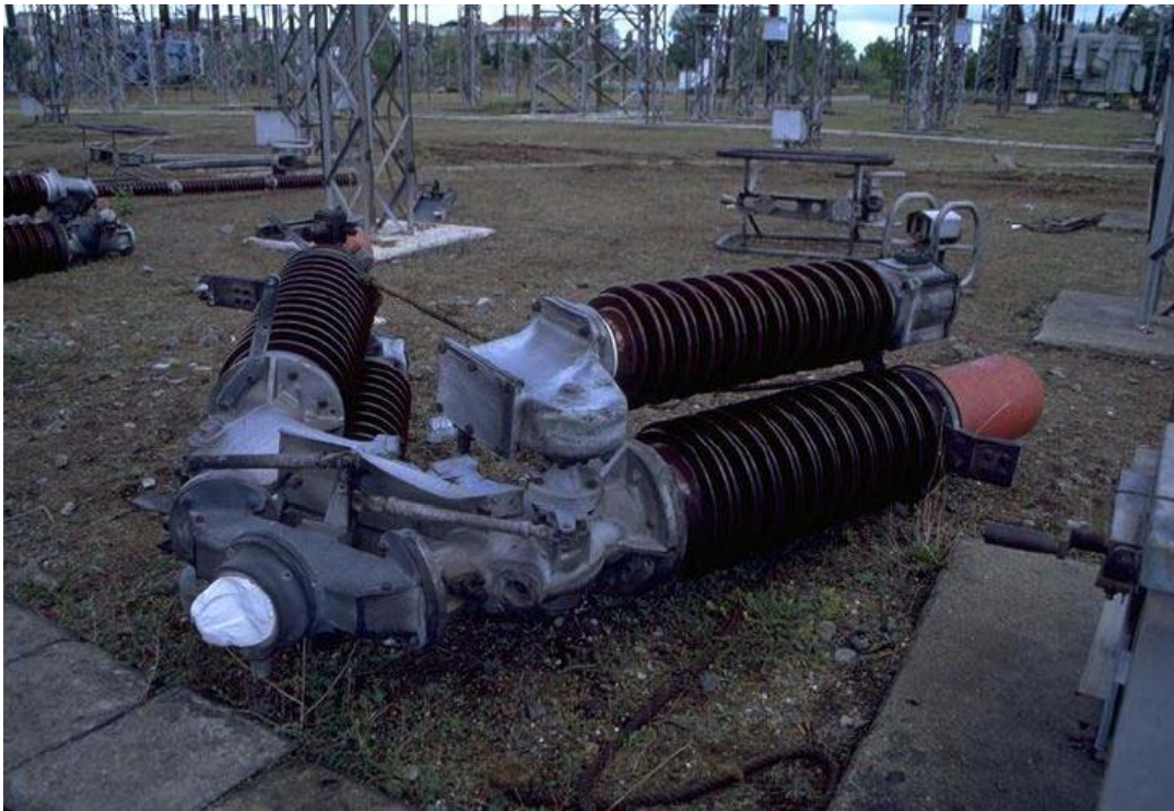
الشكل (4) تحطم قطب التوتر العالي لقاطع الاستطاعة.
