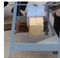
انفصال طبقة التغطية متوسط إجهاد انهيار لاصق العينات: \sigma_{pa} = 0.04 \text{ MPa}
