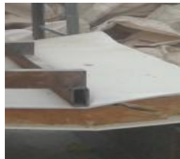
b: صورة انهيار قصي للنواة بزاوية 45 درجة
