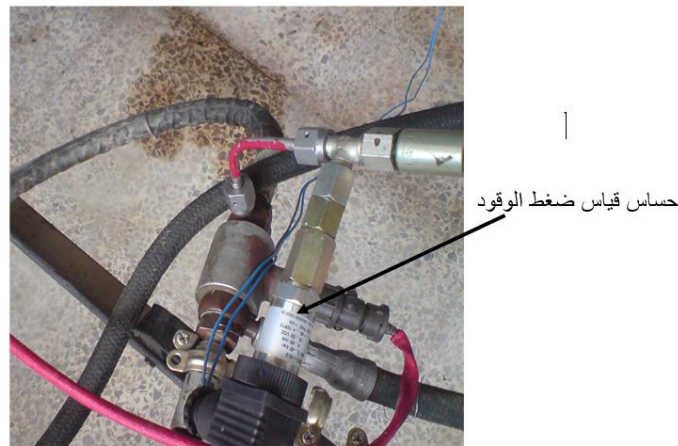
الشكل (8) حساس قياس ضغط الوقود المقدم للمحرك
