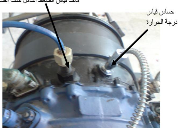
الشكل (5) الحساسات المركبة خلف الضاغط
