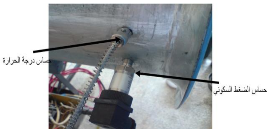
بالشكل (4) الحساسات المركبة على مدخل المحرك
