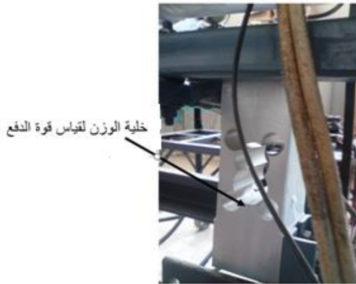
الشكل (7) حساس قياس قوة الدفع
