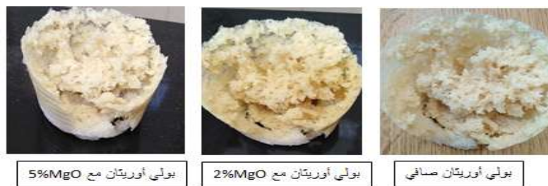
الشكل(8). عينات البولي أوريثان مع نسبة خلط تحوي 80% ايزوسيانات.
