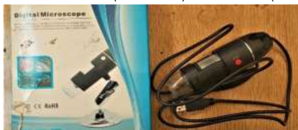
الشكل (5). الجهاز الميكروسكوبي المستخدم بقوة تكبير 500X
