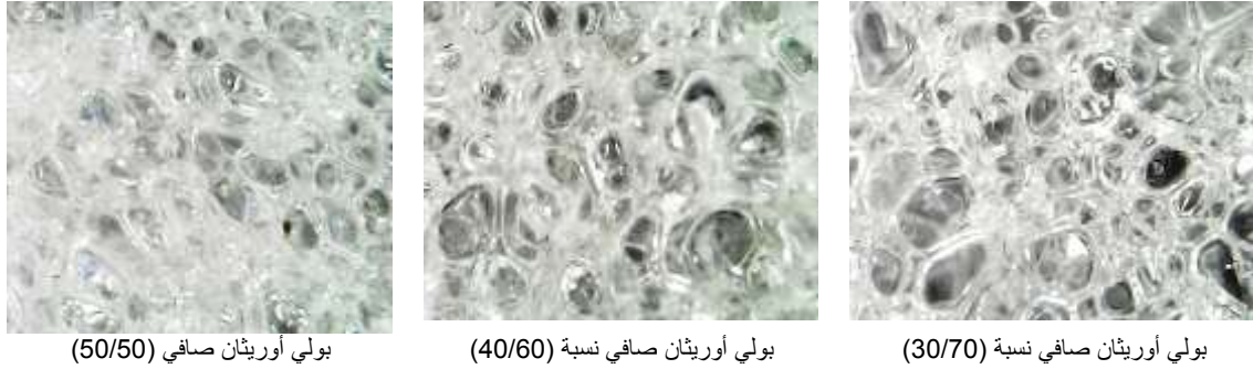
الشكل (10). الصور الميكروسكوبية بتكبير (500X) لعينات البولي أوريثان بدلالة نسبة الخلط من البولي يول و الايزوسيانات
