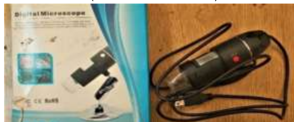
الشكل 3. الجهاز الميكروسكوبي (Digital Microscope) بتكبير 500 X.
