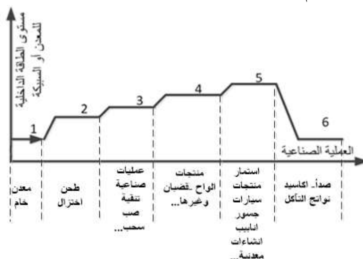
الشكل 1. عودة المعادن إلى طبيعتها (التآكل) بعد عمليات التصنيع المختلفة [1].
