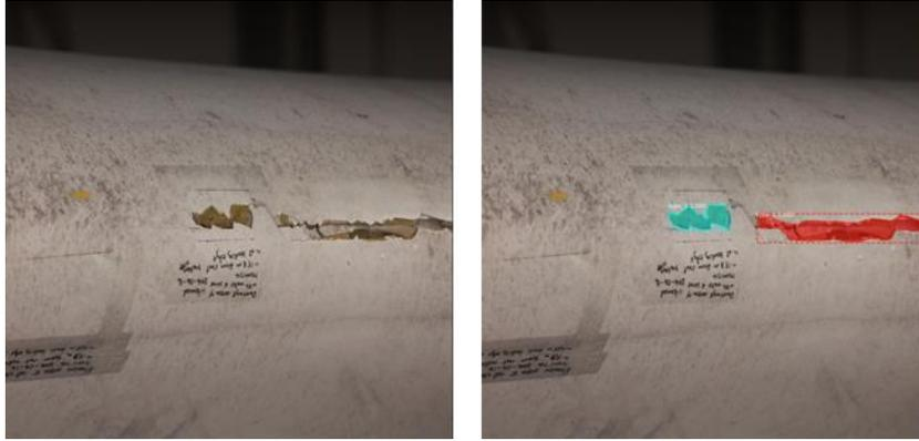
الشكل 13. خرج النموذج عند اختباره على صورة لتآكل من نوع SDD
