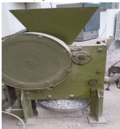
الشكل رقم(1) يبين نفايات البيتون التي تم جمعها والكسارة الأوتوماتيكية المستخدمة لإنتاج التدرج الحبي
