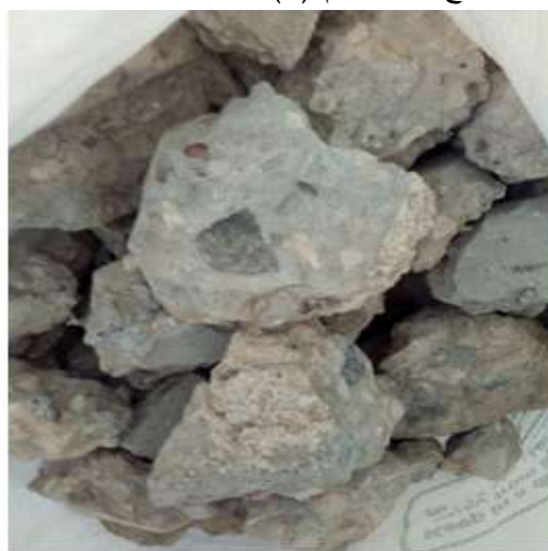
الشكل رقم(1) يبين نفايات البيتون التي تم جمعها والكسارة الأوتوماتيكية المستخدمة لإنتاج التدرج الحبي
