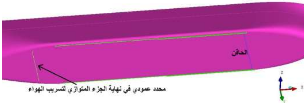
الشكل 11: محدّد عمودي على اتجاه التدفق في نهاية القسم المتوازي من أجل تسريب الهواء قبل دخوله إلى منطقة عمل الرفاص.
