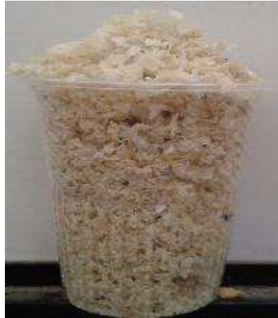
الشكل (1) - مجروش نفايات رقائق البولي إيثيلين منخفض الكثافة (RLDPE)
