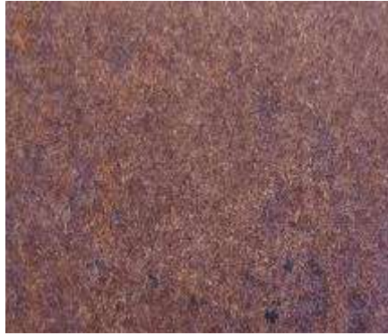
الشكل (4) - الشكل العام لعينة اختبار (40% نفايات بودرة الخشب و 60% بولي إيثيلين معاد تدويره)
