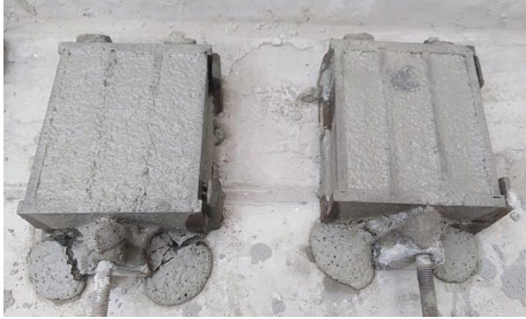
الشكل (٤) عينات البيتون الرغوي الطري بعد صبه باستخدام طريقة الخلط الميكانيكي
