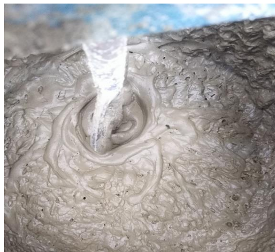
الشكل (٣) قوام البيتون الرغوي الطري المصنع باستخدام طريقة الخلط الميكانيكي
