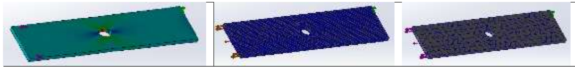
الشكل 1. محاكاة العينة المختبرة لشبكة بعدد عقد اصغري (a) وشبكة بعدد عقد اعظمي (b) تحت اجهاد شد حيث تظهر (c) توزع الاجهادات عند اجراء المحاكاة
