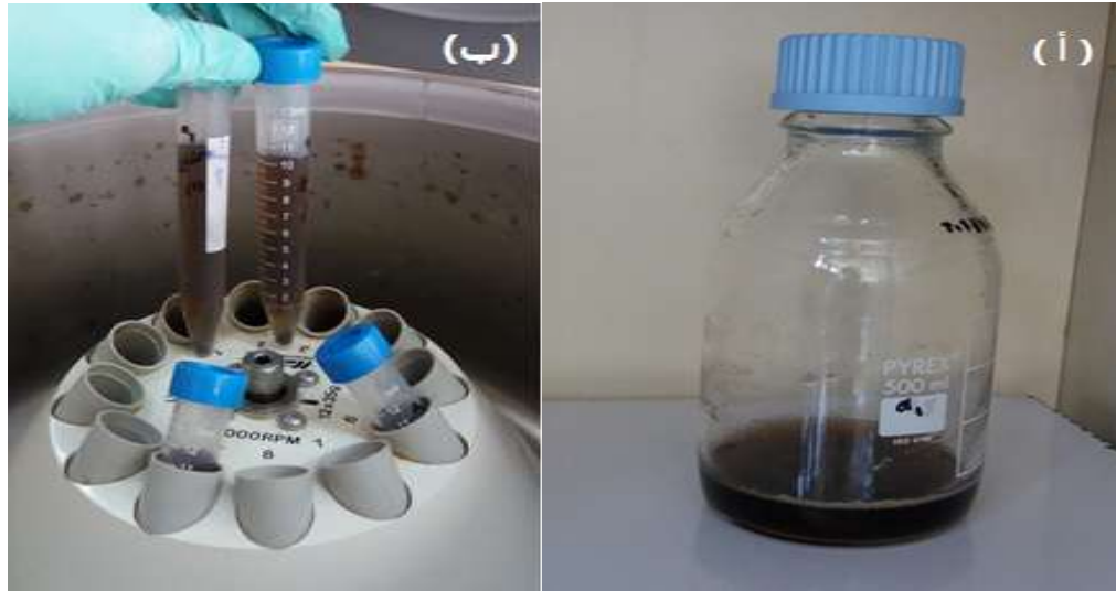
الشكل (2): (أ) وسط إنتاج الميلانين (المرق - التيروسين) باستخدام MKa1 بعد انتهاء التجربة 30 يوم عند الدرجة C 37، (ب) المرحلة الأولى من استخلاص الميلانين تثفيل وسط الإنتاج المتلون بعد انقضاء مدة التجربة لترسيب الكتلة الخلوية.
