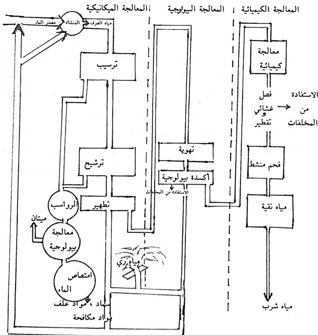
شكل (2): مراحل تنقية مياه الصرف الصناعي [4].
