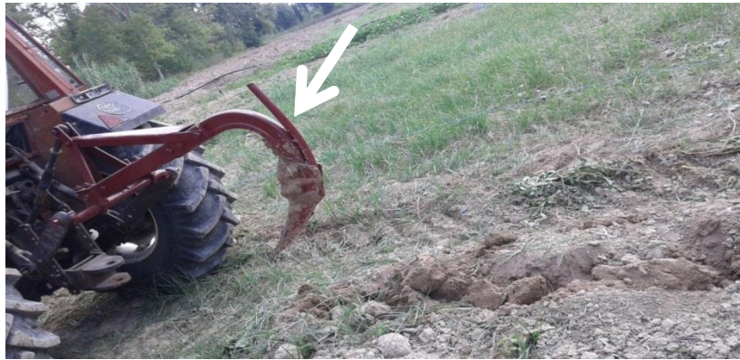
الشكل(3) يوضح سلاح التفكيك الميكانيكي قبل دخوله في التربة
